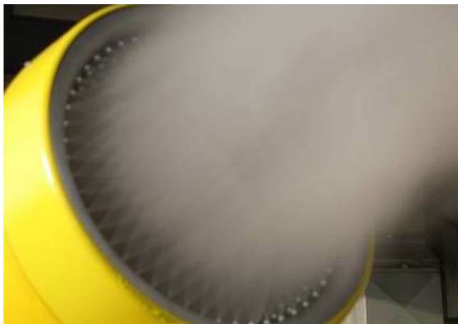
Esempio bocca di nebulizzazione per abbattimento polveri
